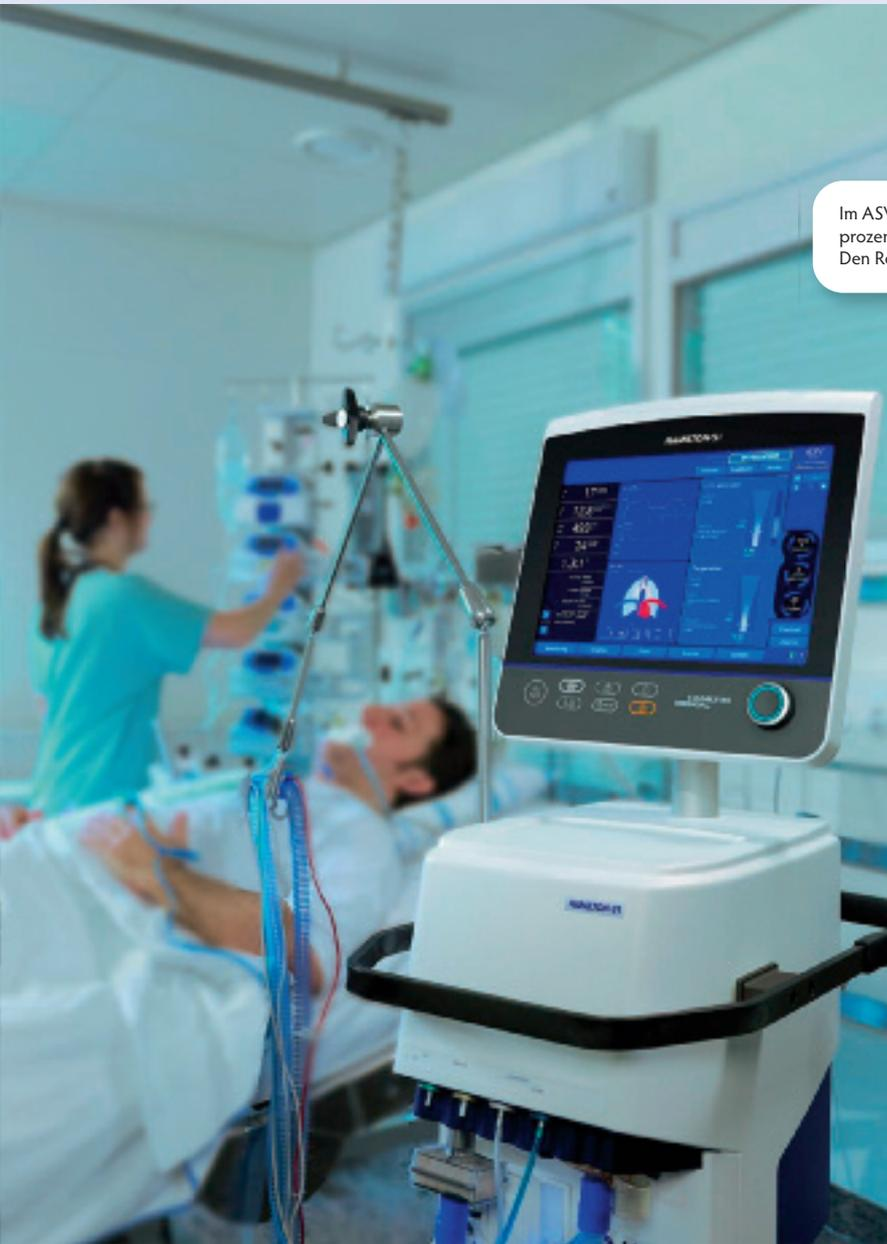
Im ASV-Modus sind lediglich der PEEP, der FiO2 und die prozentuale Unterstützung des Respirators einzugeben. Den Rest regelt die Maschine selbst.
